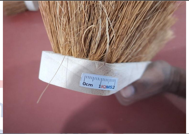
Broken Side Edge
